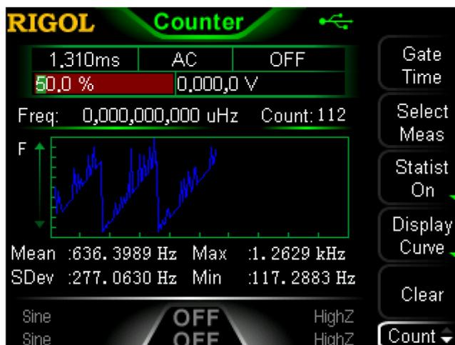
図 2-15 統計結果インターフェイス（カーブ表示モード）
