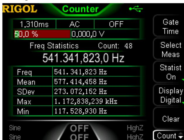
図 2-14 統計結果インターフェイス (デジタル表示モード)
