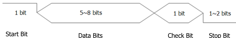
Figure 5-13 RS232 プロトコル
