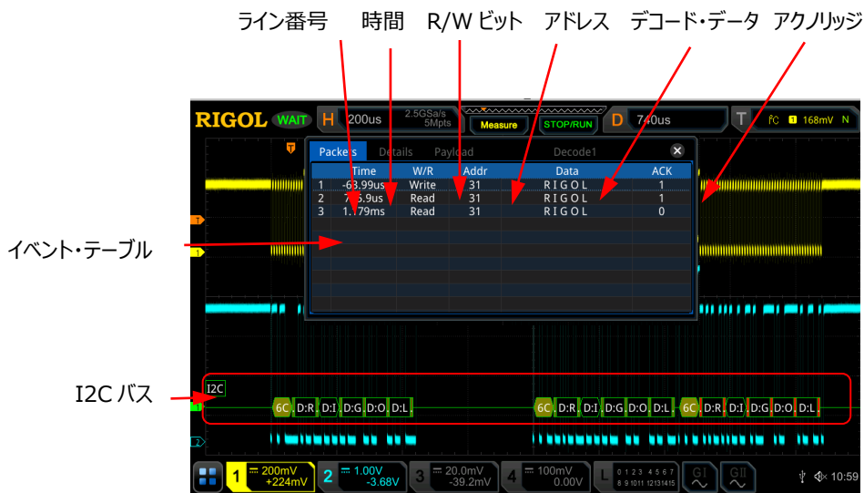
Figure 11-6 I2C デコード・イベント・テーブル
