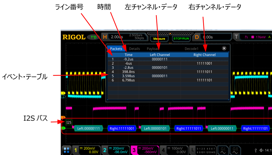
Figure 11-14 I2S デコード・イベント・テーブル
