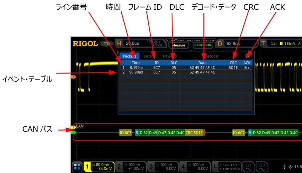
Figure 11-11 CAN デコード・イベント・テーブル
