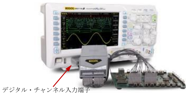
図 1-6 ロジック・プローブの接続
